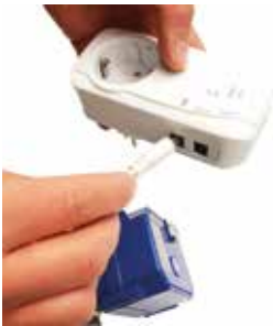
1. Inkoppling av ventilen görs på höger sida av enheten. (2 st ventiler kan anslutas)
