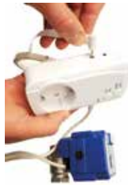
2. Vattensensorn kopplas in på vänsternsida av enheten. (2 st sensorer kan anslutas)
